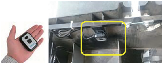
図2 GPS計測器(前席下に設置)
