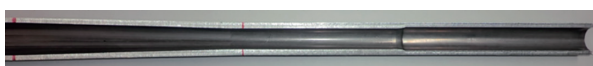
図5 心金を用いたスウェージングで試作したハンドル端部の形状
