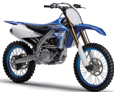
図1 YZ450Fに採用されている軽量アルミニウム製テーパードハンドル
