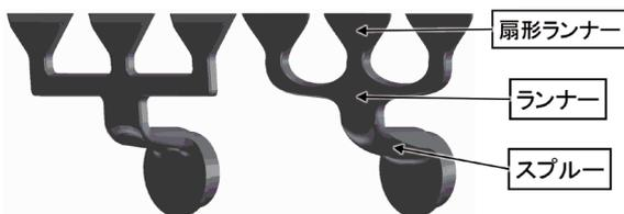
図16 初期方案形状(左)と最適方案形状(右)
