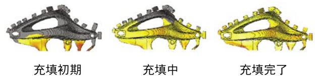
図 4 リアアーム鑄造シミュレーション
