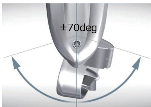
図6 電動ステアリング舵角範囲
