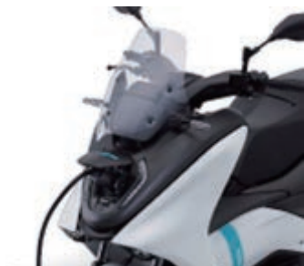
図9 フロントに設けた充電コネクタ
