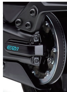
図8 後輪のベルトドライブ構造
