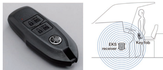
図6 スマートキーとその仕組み
