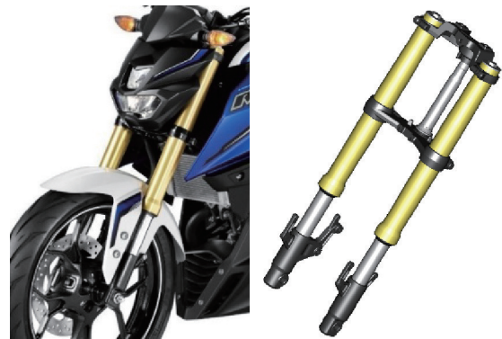
図5 倒立式フロントフォーク
