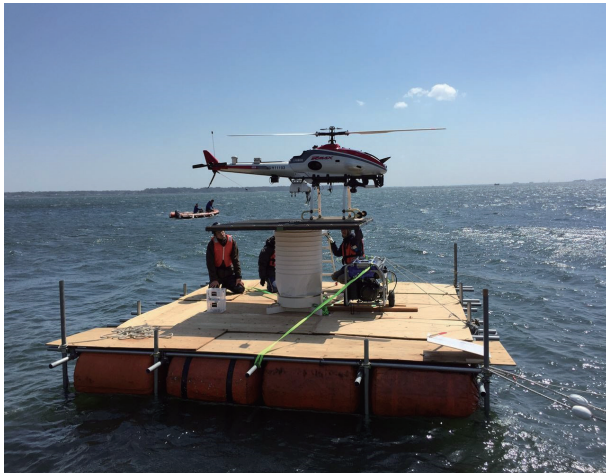
図2 船舶揺動安定装置の機能確認
