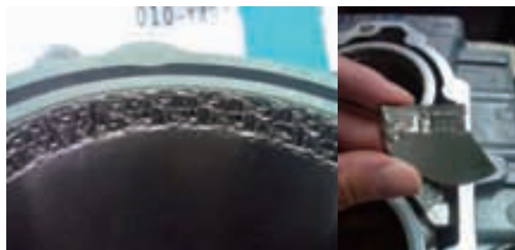
図10 主軸剛性の影響(びびり)
