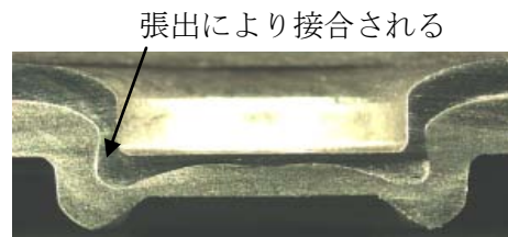
図3-2 メカニカルクリンチ断面
