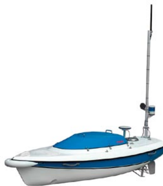
図1 自律型無人小型電動観測船の外観
