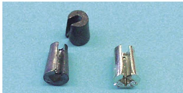
図6 バランス（左：鉛製 右：スズ製）
