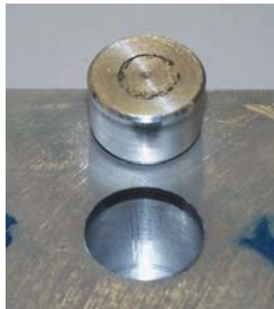
図6 圧入後に取り外したテーパープラグと穴 (カジリは見られない)
