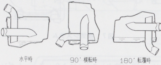
図9 ウォーターロック内部構造と残水
