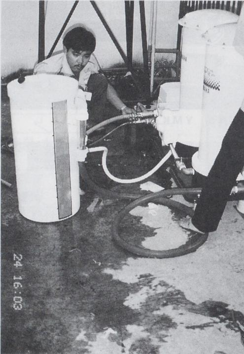
写真8 定期メンテナンス風景(水量測定)
