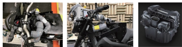
図8 開発中のダクト形状と製品形状
