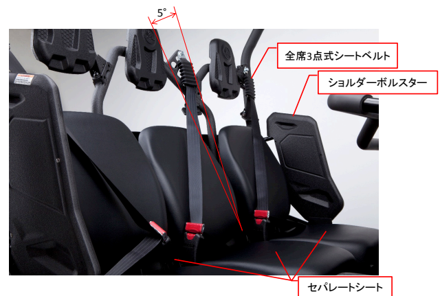
図4 フィット感、ホールド感を確保する分割シート
