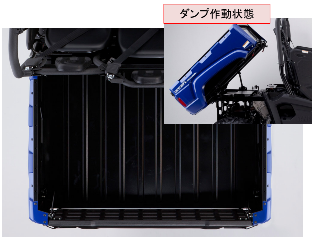
図3 積荷の上げ下ろしに便利なダンプ式リヤカーゴベッド
