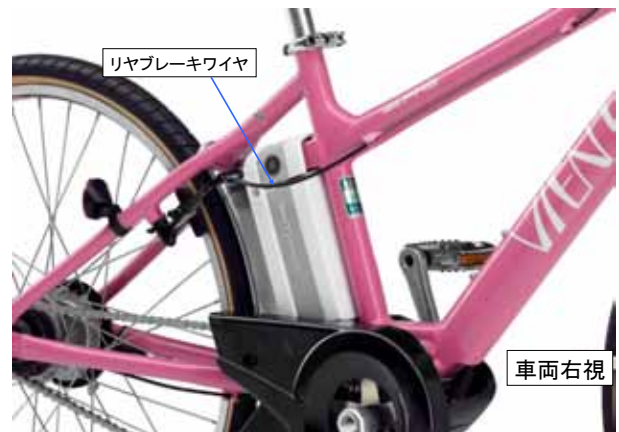
図11 リヤブレーキレイアウト (製品)
