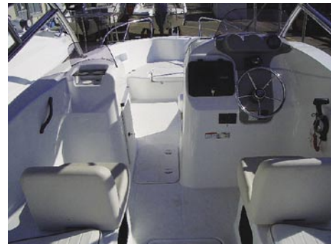
図14 AeroSports 21の左右非対称ダブルコンソール
