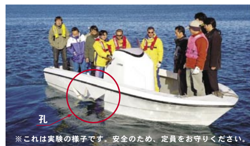
図3 BS-21の船底/船側に孔を開けて浸水させた状況
