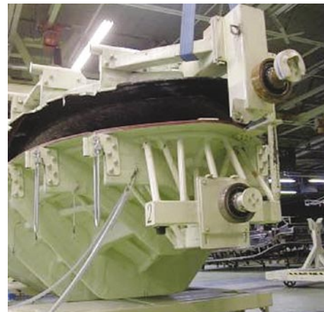
図19 アウターとインナーのカップリングの様子
