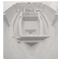
図18 デッキ接着前の船体
