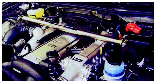
図4 パフォーマンスダンパ装着例
