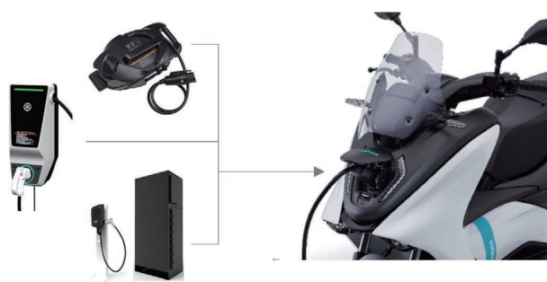
図4 IEC 62196-6規格のコネクタを採用接続部を共通化することで様々なタイプの充電器を利用できるようにした
