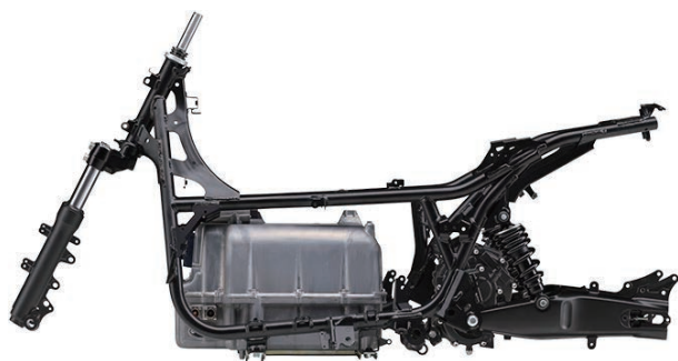
図2 4.9kWhの大容量ながら「NMAX」相当の車格に収まるコンパクトさ
