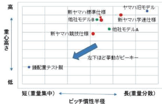
図8 慣性半径、重心高さのポジショニングチャート
