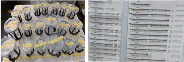
図18 レイヤー毎に樹脂重量を計量し チェックリストに記録・管理する。
