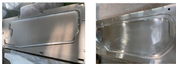
図17 センターボード用型（左）、ラダー用型（右）
