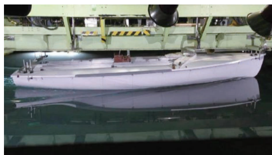
図4 水槽試験の様子 (実艇を使ったヨットの水槽試験は希少な経験となった)
