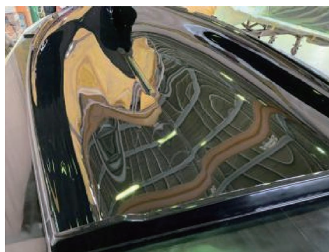
図16 完成したハルメ型。表面が鏡のようになるまで磨き上げる。
