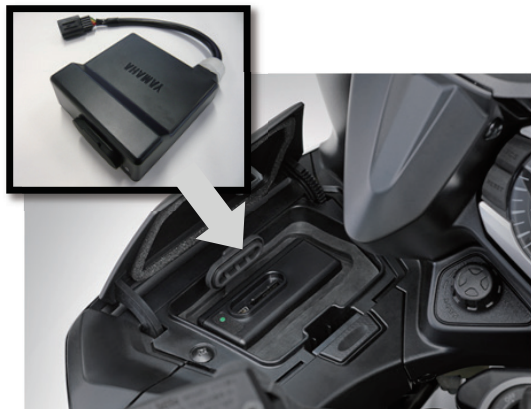
図2 車載記録ユニット搭載位置
