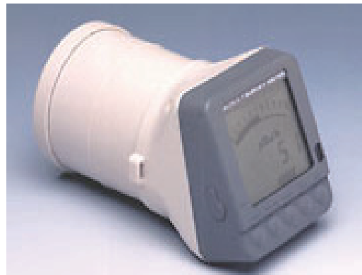
図 3 電離箱式サーベイメータ (アロカ社製 ICS-323)
