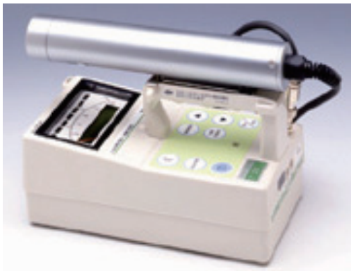
図 2 NaI(Tl) シンチレーションサーベイメータ (アロカ社製 TCS-171)
