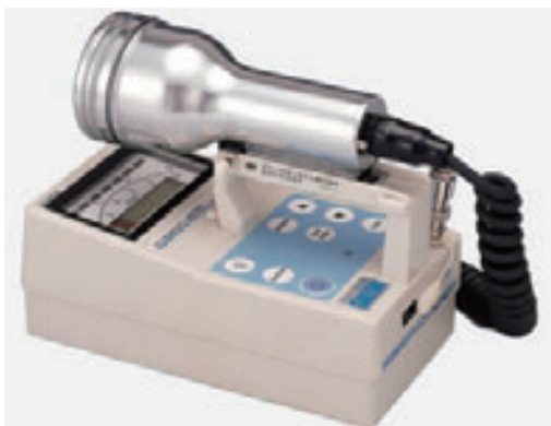
図 4 GM 管式サーベイメータ (アロカ社製 TGS-136)
