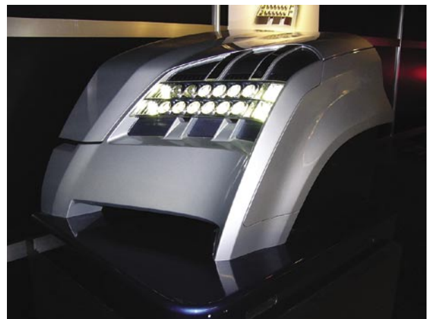
図5 LED 前照灯 (小糸製作所、資料より抜粋)
