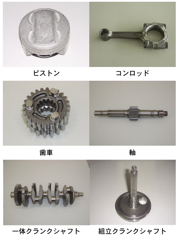
図1 二輪車の主な鍛造部品
