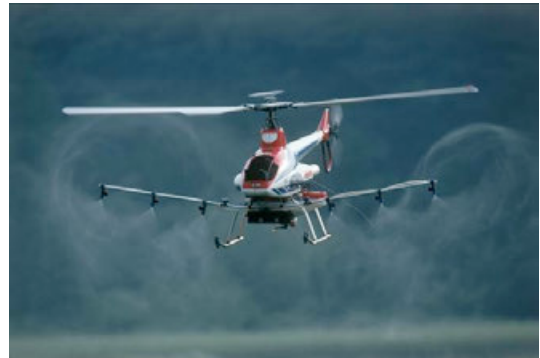
産業用無人ヘリ「R-50」による液剤散布。メインローターのダウンウォッシュが液剤を拡散させている様子がわかる。搭載している散布機などもすべて機体ごとに専用開発し、より効率の良いものへと進化し続けている
