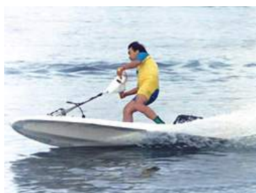
1984 年、テストのために米国に持ち込まれたプロトモデル「パワースキー」。25 馬力の船外機用エンジンが搭載された立ち乗りタイプのウォータービークルだった
