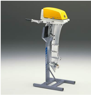
ヤマハ船外機の第1号機「P-7」(1960年)。 空冷・2ストローク・123ccエンジンを採用し、 木造和船の動力として開発した
