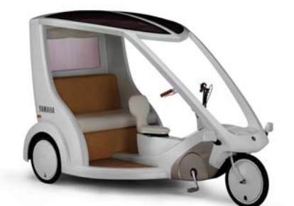
日本で開催された万博の会場内の移動ツールとして人気を集めたヤマハ製の自転車タクシー。「PAS」ユニットを搭載し、ボディにはボートやゴルフカーの製造で実績のあるFRPが用いられた
