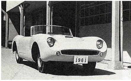
1960年に開発した試作車「YX-30（Ⅰ型）」。世界初のオールアルミ製エンジンにチャレンジし、テスト走行では最高速 144km/h を記録した
