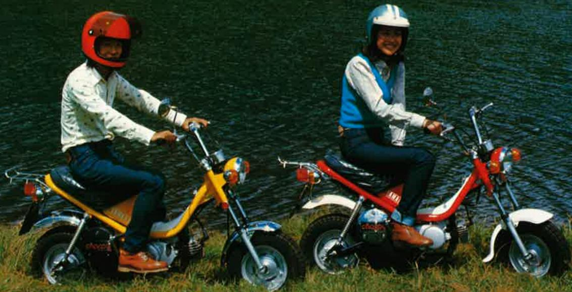
扱いやすく、乗りやすく。この思想を、ファッションブルなスタイルと鮮やかな色づかいで表現した、まったくモダンな感覚のバイクです。そして、運転操作のラクな低いシート高(約68cm)、乗り降りの簡単なアンダーボーンタイプのフレームが女性の方でもラクラク。粘り強く、のびの良いリードバルブ付の2サイクル・エンジンは80ccと50ccの2機種。それぞれに、まったくチェンジ操作のいらないオートマチック2段切換式とスポーツ走行を楽しむハンドクラッチ・ロータリー4段式の2つを用意しました。すべて1人乗りの“チャッピー”です。
