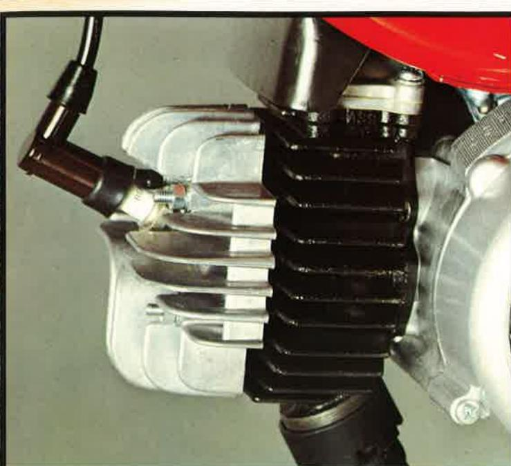
●粘り強く、のびが良いピストンリードバルブ採用の2サイクルエンジン。
