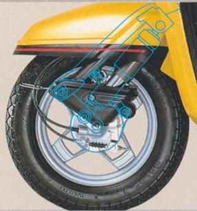
メカニカル・アンチダイブ機構とガスクッションによる鍛えこまれた足まわり。前輪にはコンプレッションバーによるメカニカルアンチダイブ機構を装備。ブレーキング時のノーズダイブを大巾に軽減します。前後輪にはガスクッションを採用。高性能エンジンにふさわしい足まわりの充実で快適な走行感が味わえます。
