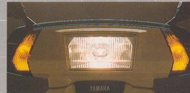
ヘッドライトは30W/30Wの上下切換式。明るいハロゲンヘッドランプです。147cm<sup>2</sup>という大型レンズを採用していますから、夜間走行も安心です。
