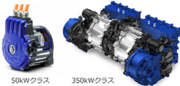
高出力帯モビリティ製品での搭載を想定して開発した350kWクラスのユニットは、ギアとインバーターが一体となったコンパクトな構成の「機電一体型」で、最大電圧800Vで使用可能です。このユニットは、1台の車両に4機搭載の場合で最大1.47MW（2,000馬力）のアウトプットが可能です。
