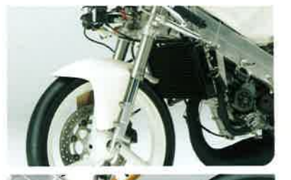
良好な作動性と剛性の高さを両立させた、アップサイドダウンタイプのフロントフォーク
