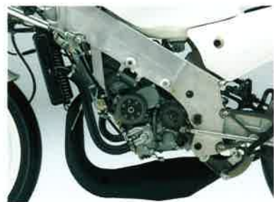
水冷単気筒のクランクケースリードバルブエンジンは、吸気通路をストレートにした高効率設計
