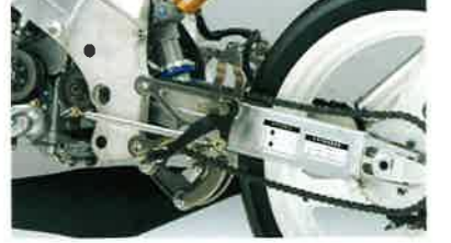
リンク式リアサスペンションは、ビギーバック型の一体式リザーバーを採用
