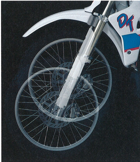
倒立フォーク:最もセッティングに注意を払ったパーツのひとつである。ホイールトラベルは300mmのロングストロークを誇る。
