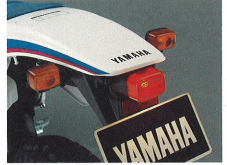
ボルト脱着式テールランプ&ライセンスプレート
