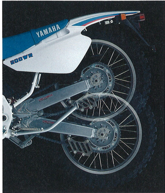
ピギーバックリアサスペンション:そのホイールトラベルは、クラス最大の310mm。サブタンクは、冷却効果の高いアルミシリンダーが採用されている。
