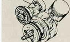
クランク軸と別軸に50%の質量を分担するバランスウエイトを設け、逆方向に回転させることにより、上下、前後方向の慣性力が同時に打消され低振動で乗り心地の良いスムーズなエンジンを実現しました。
