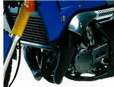
エンジンがTZR250のものと同じである以上、当然トランスミッションもドライサンプ式のものを採用。オイルパンが存在せず、トロコイドポンプによってオイルを圧送して、直接ギヤシャフトやクラッチを潤滑するため、フリクションロスが最小限に抑えられている。また1速のギヤ比をTZR250よりも大きな2.571とし、さらに2次減速比も3.286とするなど、発進加速性能や市街地での走行性を一層充実させている。
