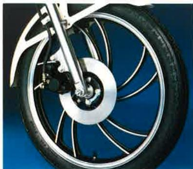
スーパーフィフティは制動力も高性能。前輪に④油圧式ディスクブレーキ採用。シャープなレスポンスを示すパワーユニットに対応して、RZ50は耐フェード性の高い油圧式ディスクブレーキを前輪に配しています。後輪は防塵防水式の大径ドラムブレーキ。リヤブレーキにはライニングの摩耗状態を確認できる⑤摩耗インジケータを設置。また、タイヤは前輪2.50-18-4PR。後輪はクラス最大の2.75-18-4PRと、グリップのよいラージサイズ。これに精悍なデザインの⑥イタリアックタイプのキャストホイールを組み合わせて、バネ下重量の軽減をはかりました。
