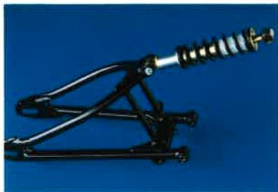
卓越したコーナリング性能を約束する①モノクロスサスペンションと、②ダブルクレードルフレーム。ヤマハが世界GPマシン用に開発し、市販ロードレーサー「TZ」や「RZ250」で定評のモノクロスサスペンションを採用。95mmの長いホイールトラベルから生まれる卓越した乗り心地と、すぐれた後輪追従性が安定した走行性能をもたらします。またフロントサスは、クラス最長130mmのストロークを持つ③テレスコピックフォーク。スーパーフィフティにふさわしい高性能サスペンションシステムです。フレームは軽量かつ剛性に富んだダブルクレードルフレーム。コーナリング時のねじれに強いた
