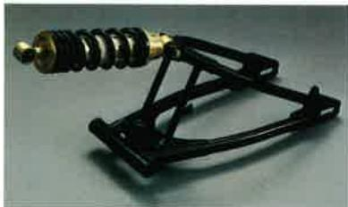
採用。軽量かつ剛性に富んだこのフレームは、エンジンに強いねじれを与えるコーナリング時にエンジンのトルクに対して、すぐれた実力を発揮します。また、リヤにはすでに高い評価を得ているモノクロスサスペンションを採用。高速コーナリング時にも、安定した走行性能を発揮します。また窒素ガス封入のド・カルボンタイプユニットは、初期荷重を5段階に調節可能としました。サウンドまでも快適だ。2段膨張式吸気サイレンサーとレーシングチャンバー型マフラーを採用。パワフルなエンジンに不可欠の吸気ノイズを低減するために、大容量の2段膨張式吸気サイレンサーをエアクリーナーケースに設けました。また大容量のエアクリーナーを燃料タンク前部裏側に配置し、吸気音の発生を防いでいます。さらにエクゾーストは、脈動効果の高いレーシングチャンバー型マフラーを採用。内部に4段膨張の隔壁を設け、排気音を低周波化。より快適にしています。新たな次元の走りを予感させる、スタイリング。ゴロワスカラーのストライプを持ち、見るからに走りに徹したRZ350は、真のスーパースポーツ
