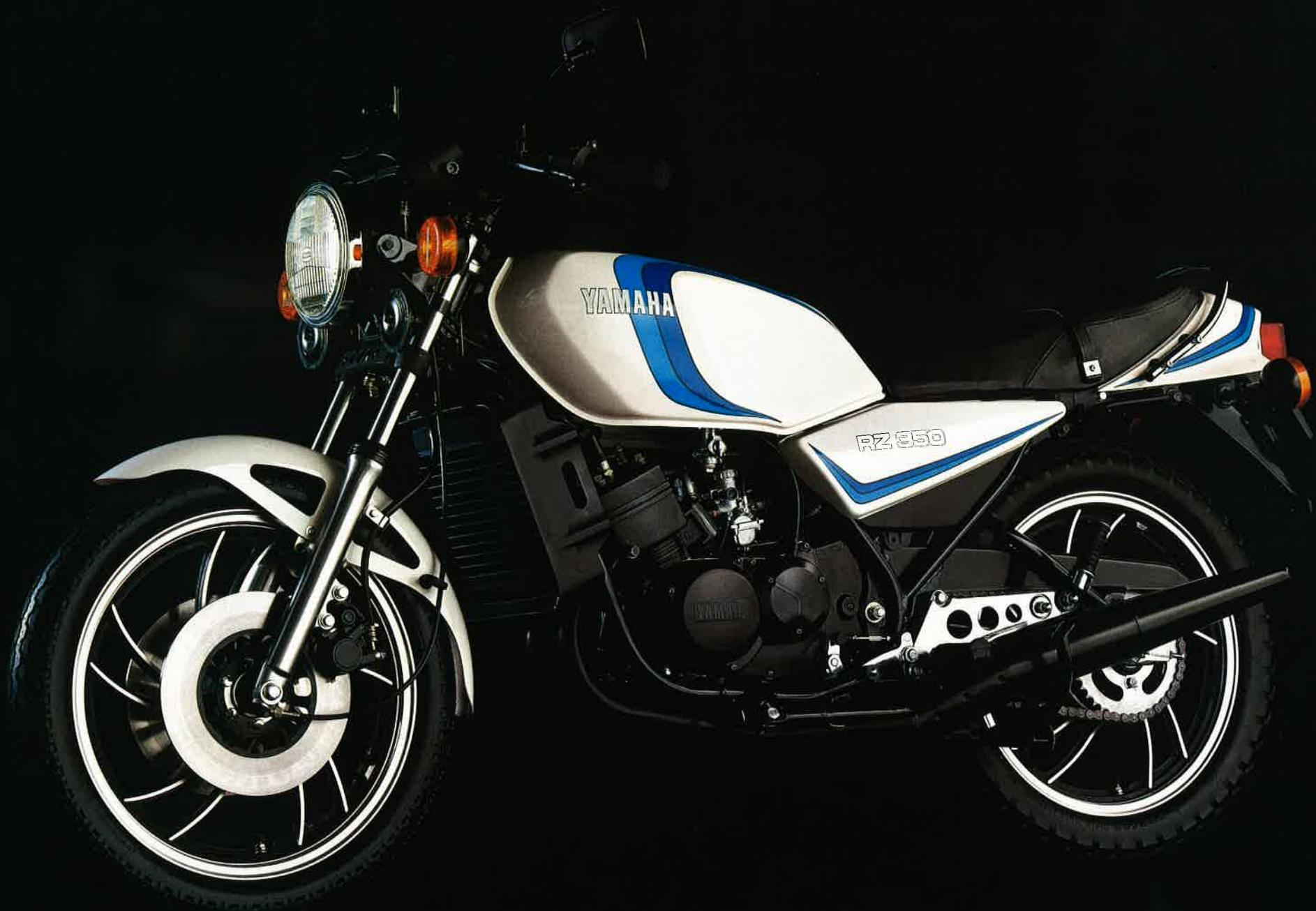
水冷2ストロークツイン347c.c。最高出力45ps / 8,500r.p.m.。
