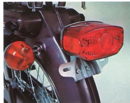
フロントブレーキを作動しても点滅するニュータイプの大型テールランプ。安全性を配慮したリフレクター付。
