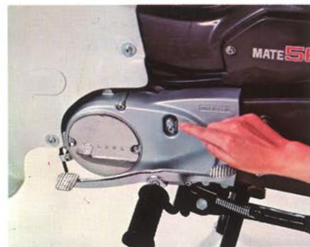
ヤマハ独自の新設計。お好みにより選べるローターリー・シーズンチェンジ切替機構を採用！ドライバーで簡単に操作できます。
