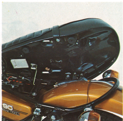
ワンタッチ開閉のできる横開き式シート。整備のしやすさは抜群。
