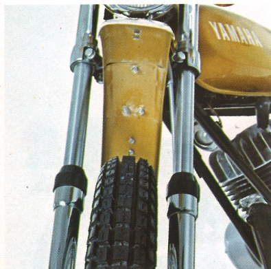
セリアーニタイプのフロントフォーク。思い切って上部に装着した角形フェンダー。大型化(19インチ)したフロントタイヤ。
