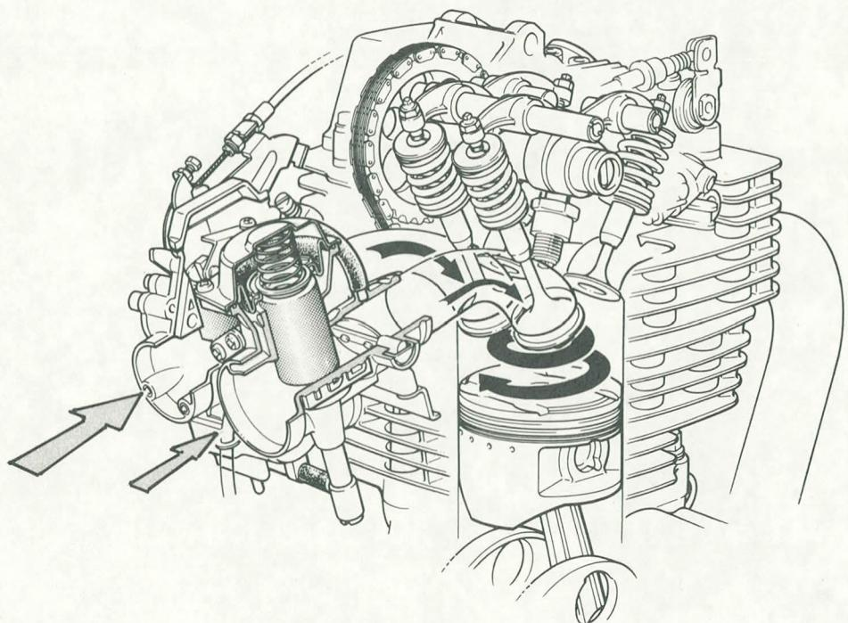
V M キャブレターの低中速回転域における瞬発力と、S U キャブレターの高速回転域におけるなめらかさの組合せで、オールラウンドに働くキャブレター・システムとしています。
