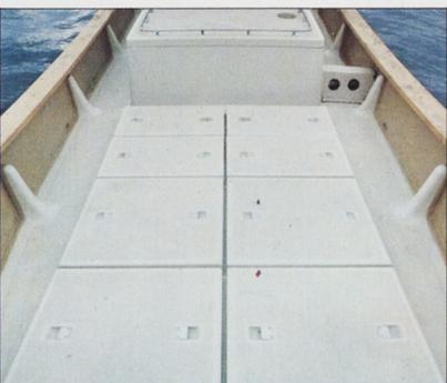
ハッチブタ＝すべてF.R.P.製。サンドイッチ構造で充分剛性のあるものとした。表面はデッキと同じすべり止め加工。
