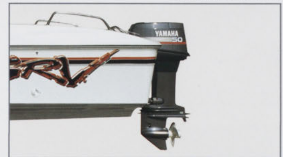
● 船外機 [50HEDOL] (浅瀬の走航を可能にする、適当な位置で船外機を固定できる、 ハイドロ・トリム・コントロール【手動】を採用しています。)
