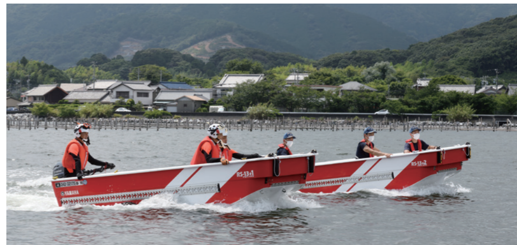
2艇の洪水・水難救助艇が並走する。航走中は高い旋回性と保針性を両立。最大速力は車輪装着状態で約15km/h（車輪無しでは約45km/h）。定員は6名だが、左右のトラックレールにサイドフロートを取り付けることで更に安定性が向上する
