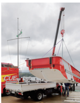
フロントゲートには長さ1550mm、幅830mmのスレッドをOPとして用意。車椅子に乗った要救助者の収容にも役立つ
