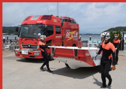
3名の救助隊員が、バルーンタイヤが付いた洪水・水難救助艇を湖面へと搬送する。艇体側面には側面のトラックレールに取り付けたキャリーハンドを引くことで容易に地上搬送が可能
