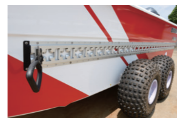
艇体側面のトラックレールと搬送用のキャリーハンドル（左端）。片側2輪の地上搬送用バルーンタイヤはブラケット（取付金具）を介して装着する。これらの取り付け作業では工具が不要
