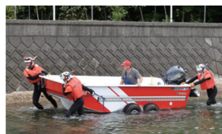
冠水地での搬送を想定した訓練においても、バルーンタイヤのおかげで多少の不整地でも要救助者を載せたまま移動が可能
