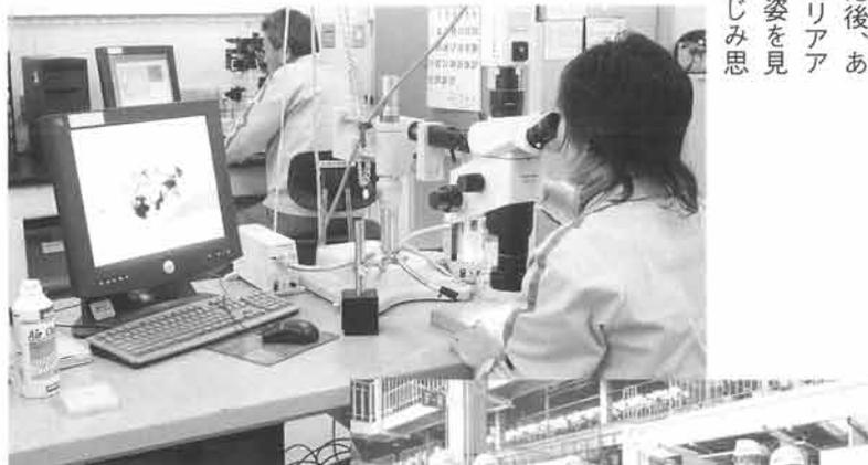
実験であえて破損させた物の破面解析を行っている様子(写真上)。こういった調査や基礎データ収集、基盤技術開発のほか、実験を行う製造現場にも積極的に足を運ぶ(写真右)。新しい技術を形にするためには、研究所のみならず、現場での試行錯誤も重要だ
