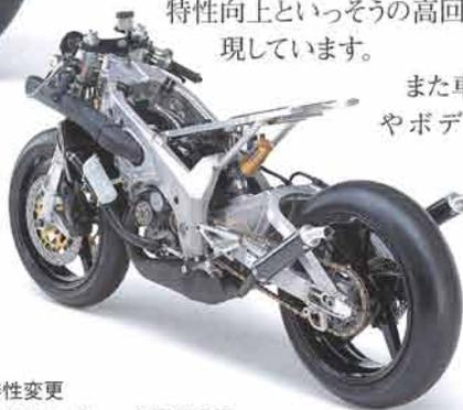
また車体外装では、フロントフェンダーやボディ、シート、リアのカウル類をYZR250タイプに一新。そのエアロダイナミクス効果に優れたフォルムが、空気抵抗を大きく低減すると同時にウィンドプロテクション効果も高め、いっそうの最高速性能向上、ライダーの疲労軽減に貢献します。なお、「TZ125」は従来モデルの継続販売です。
