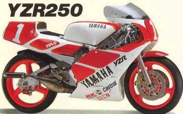
水冷・2サイクル・Y P V S 装備のV型2気筒とアルミ・デルタボックスフレームの組合わせて2シーズン目を迎える Y Z R 250。基本構成に一切の変更はなく、エンジンのパワーアップと車体アライメントの変更など一段ときめ細かい \* 熟成。を図っています。
